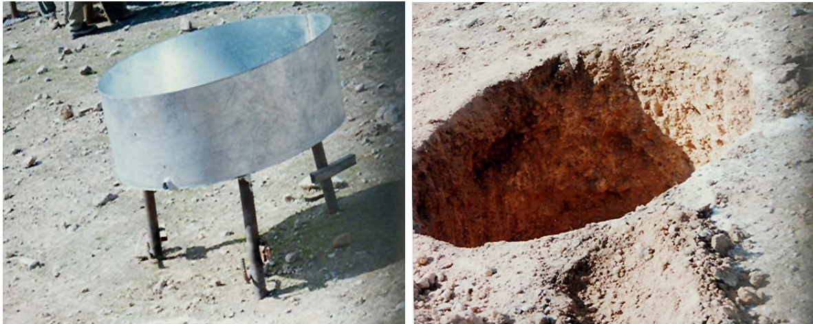
شکل ۳- حوضچه اندازه‌گیری رواناب قبل از نصب Fig 3. Runoff measuring container before installation
