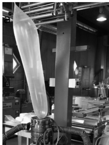
شکل ۲ - فیلم کازینات سدیم تهیه شده توسط فرآیند قالب‌گیری تزریقی [۱۴، ۱۵].
