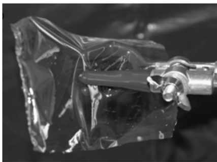
شکل ۳ - فیلم کازینات سدیم تهیه شده توسط فرآیند کاستینگ [۱۵].
