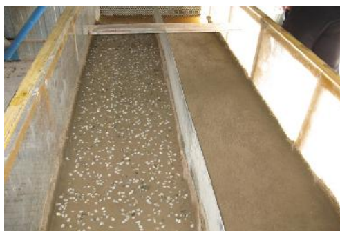
شکل ۱- نمایی از فلوم مورد استفاده و توزیع سنگ‌ریزه‌ها بر روی سطح بستر خاک
