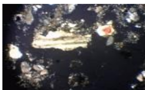
شکل ۱- نودل لایه لایه آهک -40x-XPL- P_2H_4
