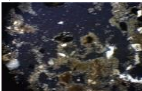
شکل ۴- پوشش‌های میکریته در اطراف منافذ -40x-XPL- P_1H_3
